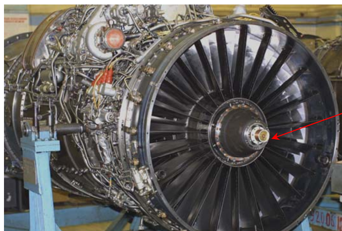
Рис. 1. Двигатель АЛ-31Ф с установленной в центре аппаратурой «АГАТ-Л»
